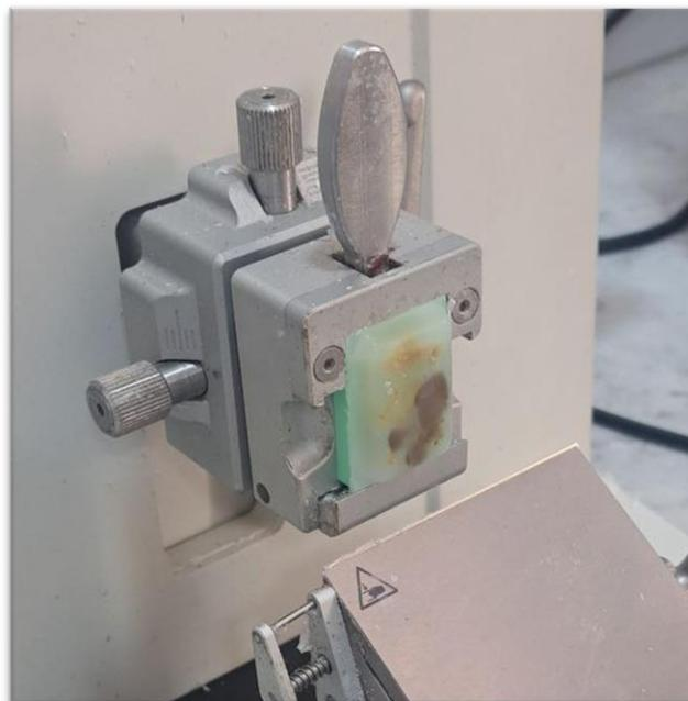
*Figure 21 : dégrossissement des blocs, au microtome à 40-42  $\mu$ .*
